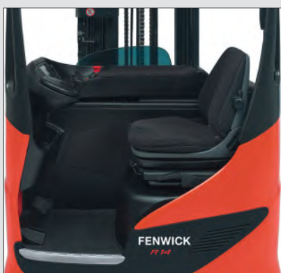
Siège suspendu pneumatique en standard
